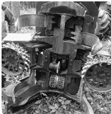
Prozesserkopf eines Vollernters
